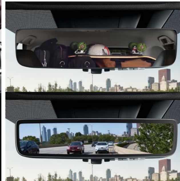
Con el nuevo retrovisor inteligente, los conductores pueden ver mejor lo que les rodea. Con solo pulsar un botón, el retrovisor interior electrocromático con regulación automática se convierte en un monitor digital de alta definición. Además, por medio de una cámara montada en la parte superior de la luna trasera del RAV4, el monitor garantiza en todo momento una vista despejada, incluso cuando hay objetos voluminosos en el maletero.
